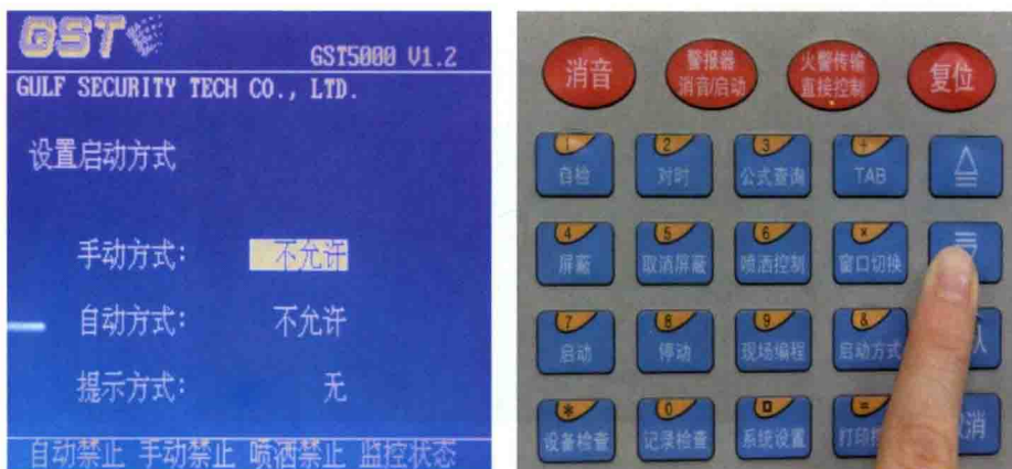
图9-28 上下键改变手动方式状态
