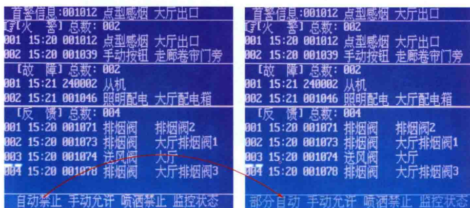
图9-38 显示屏上自动方式由“自动禁止”改为“部分自动”
