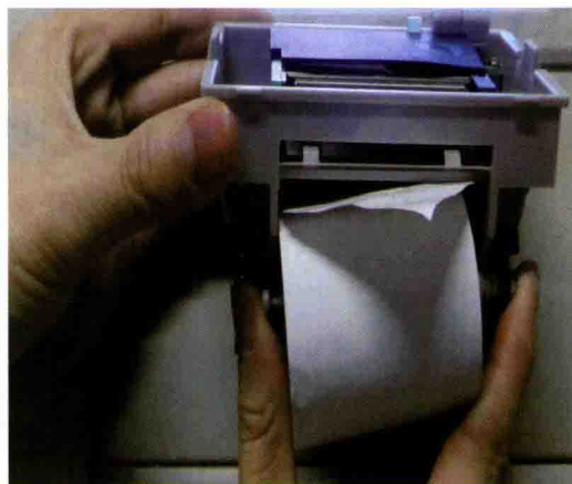
图9-20 将装好新纸的卷轴重新装回导槽内
