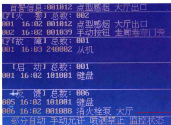
图6-79 液晶显示屏上显示消火栓泵启动
