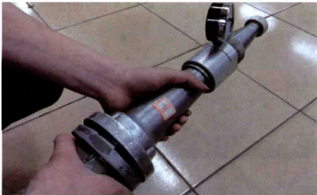
图8-43 旋下消火栓测压接头
