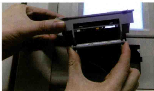
图9-18 取下打印机卷轴
