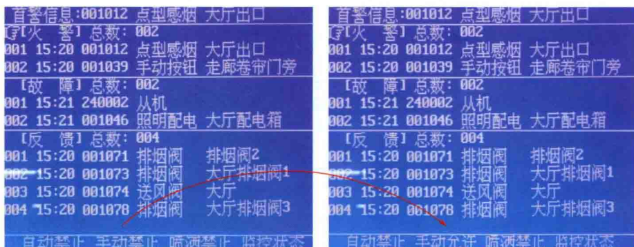
图9-30 液晶显示屏上手动状态的变化
