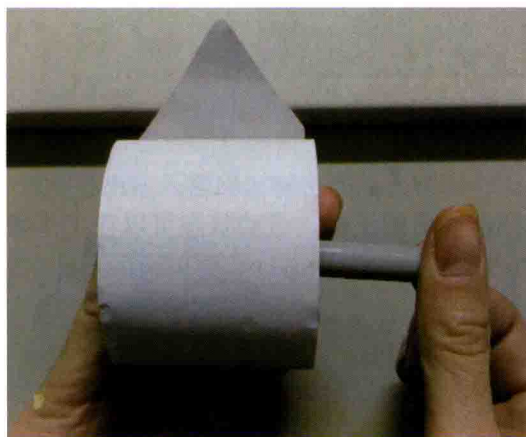
图9-20 将装好新纸的卷轴重新装回导槽内
