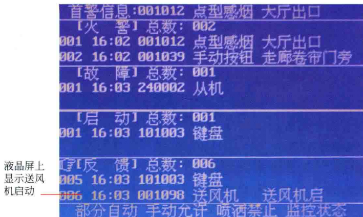
图6-85 液晶屏上显示送风机启动
