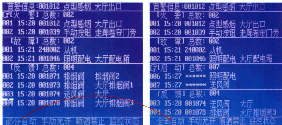
图9-39 显示屏上自动方式由“部分自动”改为“全部自动”
